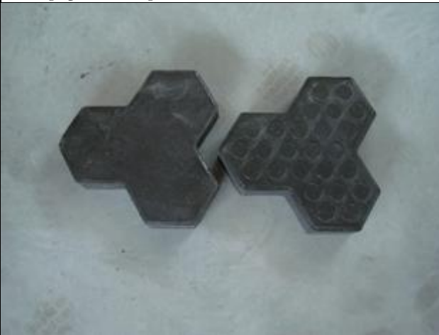
Moulage avec pression: Pavés avec du sable
