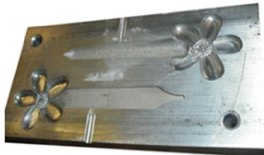
Illustration 2 : Exemple de moule en aluminium
