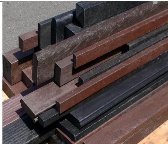
Moulage avec pression : Plastique de construction (comme bois)
