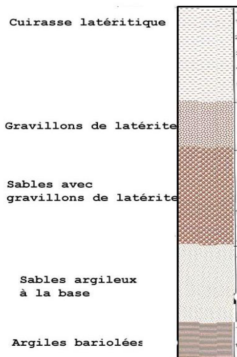
Figure 5 : Coupe lithologique typique sur le site du CET
