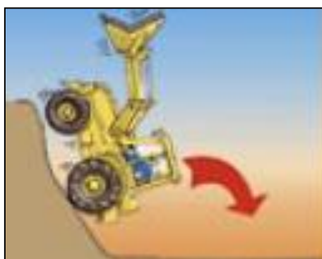
Figure 27: Risques de chute des camions sur les pentes trop raides
