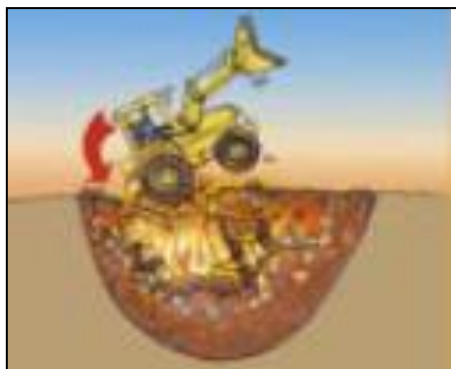
Figure 26: Risques d'effondrements dans des cavités en feux
